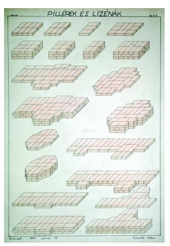
Fig. 4 Columns and Pilasters. Stratification of the brick. Susánszky Gábor. In 1944. Source: Építészettörténeti Rajztár. Volume 2. Drawing no. 103133.
