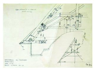
Fig. 3 Roman Catholic Church. Stock roof truss. Nagymaros. Bakó Klára. In 1955.Source: Építészettörténeti Rajztár. Volume 2. drawing no. 103831
