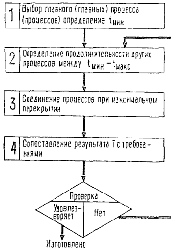
Рис. 4. Планирование наиболее короткого срока строительства
