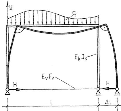
Abb. 1. Zur Berechnung der Zugstabrahmens
