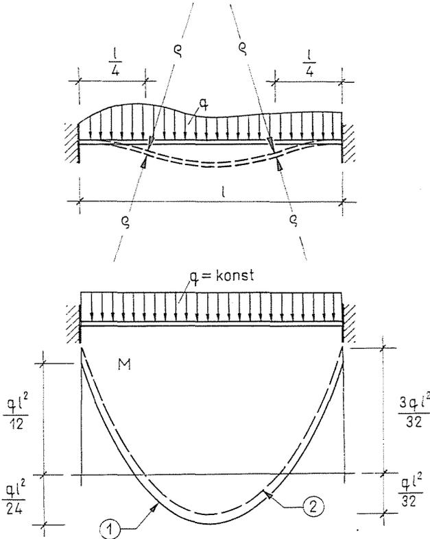
Abb. 4. Momente im an beiden Enden eingespannten Träger. 1 — nach dem klassischen Verfahren 2 — nach dem Prinzip der prädeternierten Spannungen
