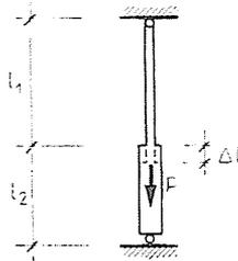
Abb. 2. Die Festigkeit der Werkstoffe im elastischen Grenzzustand läßt sich nicht in allen Konstruktionen ausnützen
