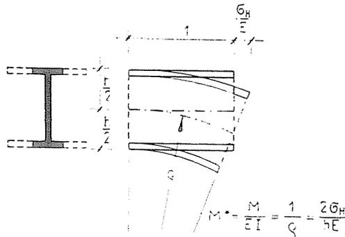
Abb. 3. Bestimmung der Krümmung im elastischen Grenzzustand
