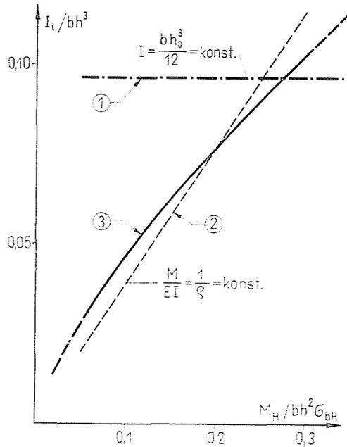
Abb. 5. Zusammenhang zwischen dem Grenzmoment und der Biegesteifigkeit des Stahlbeton-Querschnitts. 1 — nach dem klassischen Verfahren; 2 — nach dem Prinzip der prädestinierten Spannungen; 3 — der tatsächliche Zusammenhang
