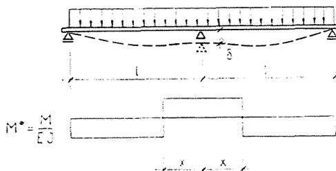
Abb. 6. Zur Berechnung des Trägers auf elastisch senkbaren Stützen
