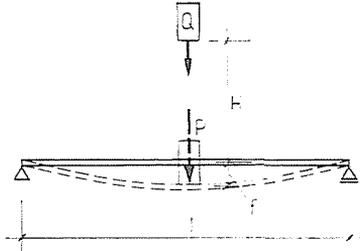
Abb. 9. Zur Berechnung des Trägers unter Schlagbeanspruchung
