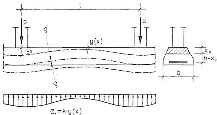
Abb. 7. Zur Berechnung des Trägers auf elastischen Stützen
