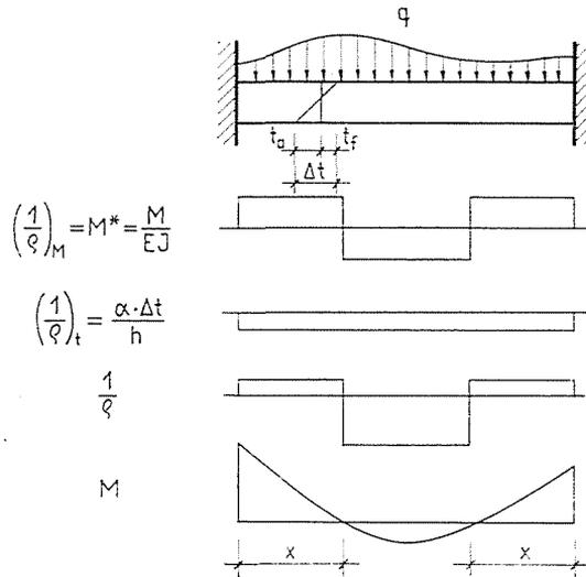
Abb. 10. Zur Berechnung der Beanspruchung durch Wärmewirkung
