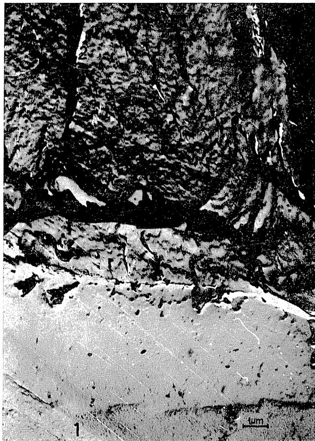
**Fig. 77.** Exposición bajo microscopio electrónico del límite de fase entre el electrocorindón (1) y el material de enlace en fusión (2) de silicato de boro ( $10\ 000\times$ )
