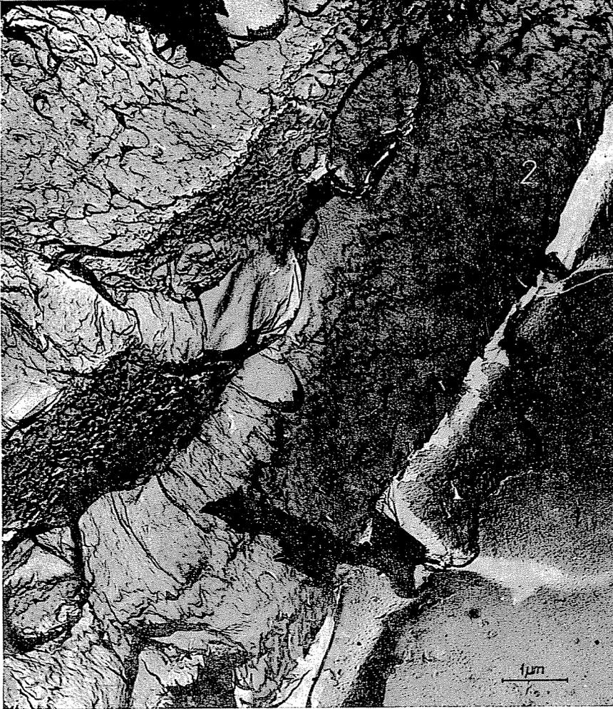
Fig. 88. Exposición bajo microscopio electrónico del límite de fase entre el electrocorindón (1) y el material de enlace en fusión (2) de silicato de boro (18 500 ×)
