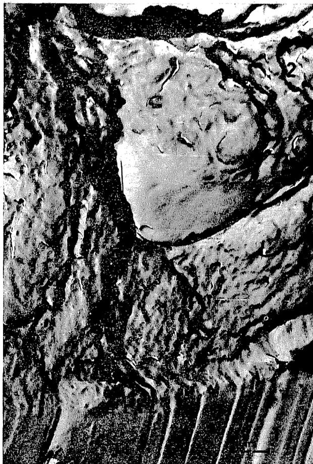
*Fig. 69.* Exposición bajo microscopio electrónico del límite de fase entre el electrocorindón (1) y el material de enlace en fusión (2) de silicato de boro ( $16\ 000\times$ )
