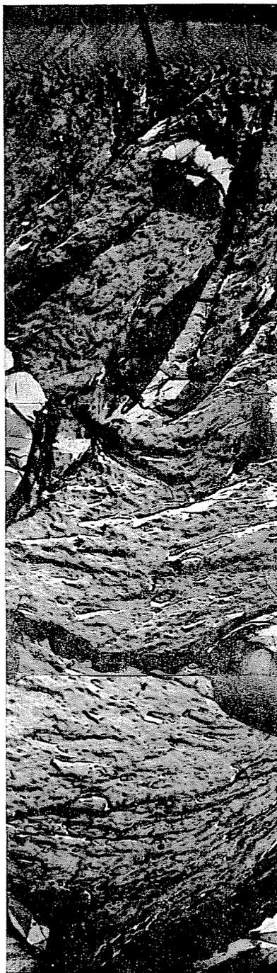
*Fig. 75.* Exposición bajo microscopio electrónico del límite de fase entre el electrocorindón (1) y el material de enlace en fusión (2) de silicato de boro (16 000 $\times$ )
