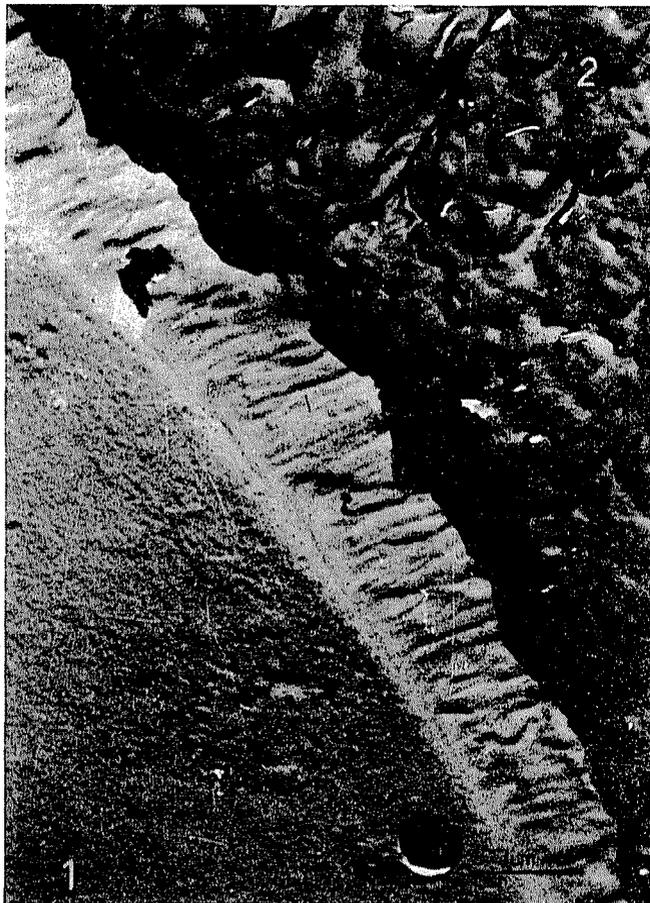
*Fig. 73.* Exposición bajo microscopio electrónico del límite de fase entre el electrocorindón (1) y el material de enlace en fusión (2) de silicato de boro ( $23\ 000\times$ )
