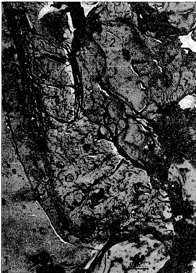
*Fig. 80.* Exposición bajo microscopio electrónico del límite de fase entre el electrocorindón (1) y el material de enlace en fusión (2) de silicato de boro (16 000×)
