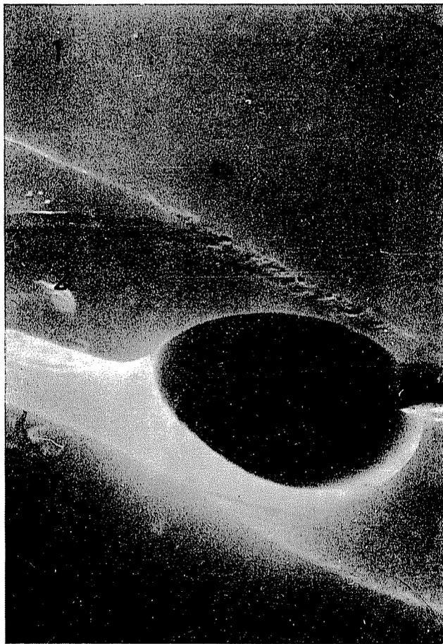
*Fig. 116.* Exposición tomada bajo microscopio electrónico de tipo scanning del límite de fase entre la partícula de carburo de silicio (1) y el material de enlace cerámico (2) (6000×)
