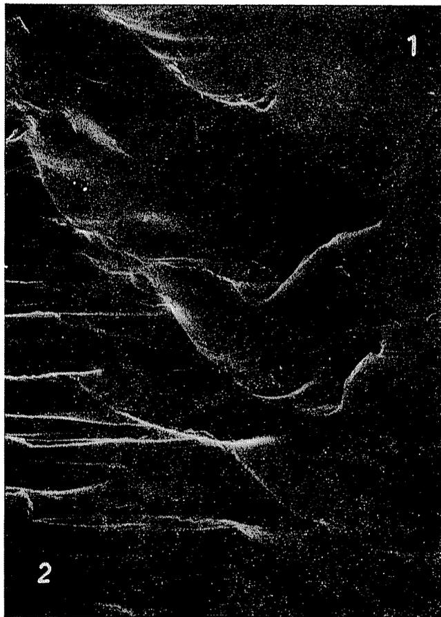
*Fig. 47.* Exposición bajo microscopio electrónico de tipo scanning del límite de fase entre el electrocorindón (1) y el material de enlace de silicato de boro en fusión (2) (6000×)
