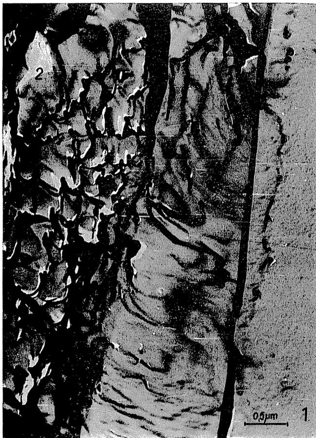
*Fig. 82.* Exposición bajo microscopio electrónico del límite de fase entre el electrocorindón (1) y el material de enlace en fusión (2) de silicato de boro ( $10\ 000\times$ )
