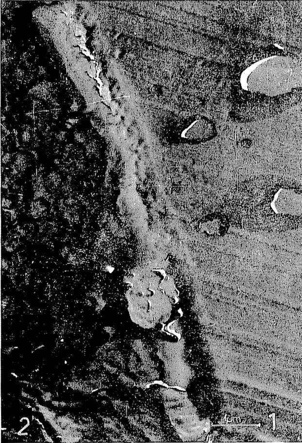
*Fig. 70.* Exposición bajo microscopio electrónico del límite de fase entre el electrocorindón (1) y el material de enlace en fusión (2) de silicato de boro ( $18\ 000\times$ )
