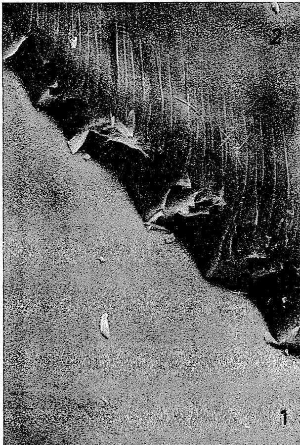
*Fig. 41.* Exposición bajo microscopio electrónico de tipo scanning del límite de fase entre el electrocorindón (1) y el material de enlace de silicato de boro en fusión (2) (1500 $\times$ ),
