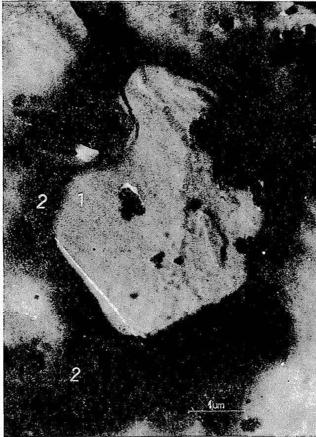
Fig. 94. Exposición con el microscopio electrónico de la superficie de un microcristal de corindón (1) después del esmerilado; en las puntas del cristal se pueden observar los “pilares de contención” (2) del material de enlace cerámico (23 000×)
