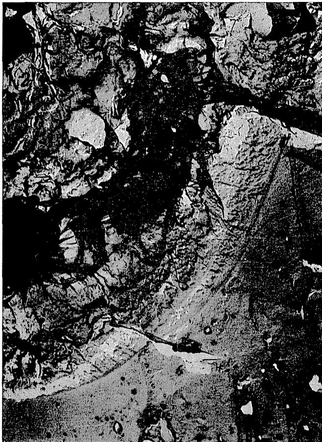
*Fig. 66.* Exposición bajo microscopio electrónico del límite de fase entre el electrocorindón (1) y el material de enlace en fusión (2) de silicato de boro (7000 $\times$ )
