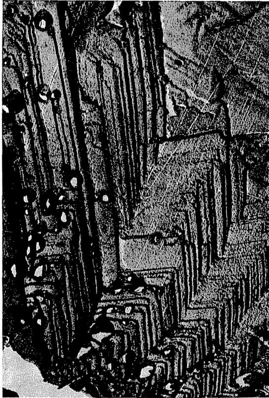
*Fig. 19.* Agrupaciones microcristalinas de diverso tamaño y variada orientación en el electrocorindón. Exposiciones bajo microscopio electrónico (8000 $\times$ )
