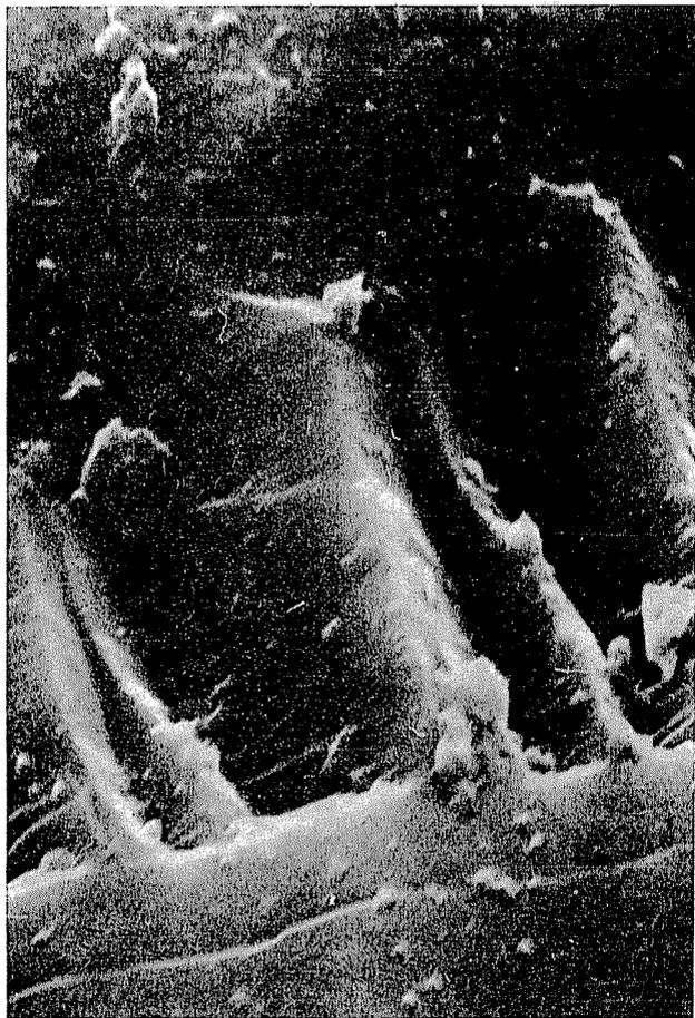
*Fig. 118.* Exposición tomada bajo microscopio electrónico de tipo scanning del límite de fase entre la partícula de carburo de silicio (1) y el material de enlace cerámico (2) (10 000×)
