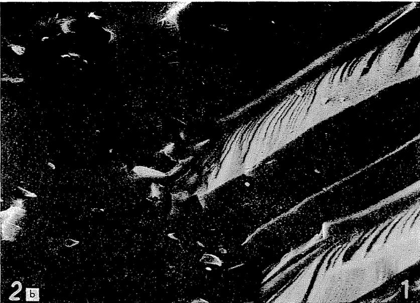
Fig. 48. Exposiciones bajo el microscopio electrónico de tipo scanning del límite de fase entre el electrocorindón (1) y el material de enlace de silicato de boro en fusión (2)
