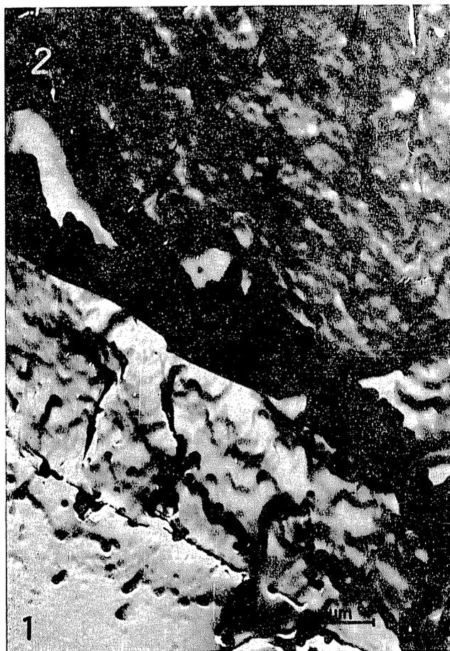
*Fig. 78.* Exposición bajo microscopio electrónico del límite de fase entre el electrocorindón (1) y el material de enlace de fusión (2) de silicato de boro (16 000 $\times$ )
