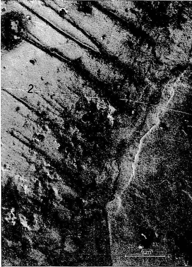
*Fig. 95.* Capa superficial de corindón puro reblandecida durante el esmerilado (1) y huellas preliminares de las fracturas en la superficie aún intacta del electrocorindón (2). Exposición bajo microscopio electrónico (27 000 ×)
