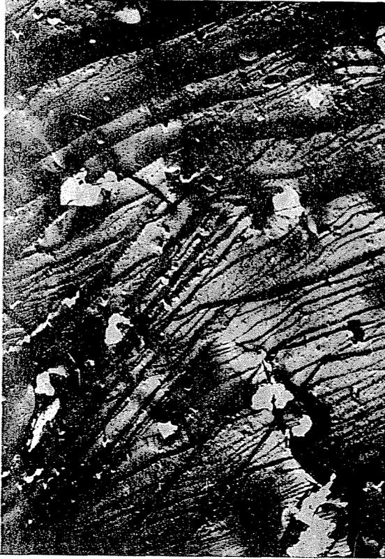
Fig. 22. Agrupaciones microcristalinas de diversa orientación y tamaño con diferentes tipos de enlace en el corindón puro. Exposiciones bajo microscopio electrónico (10 000 $\times$ )
