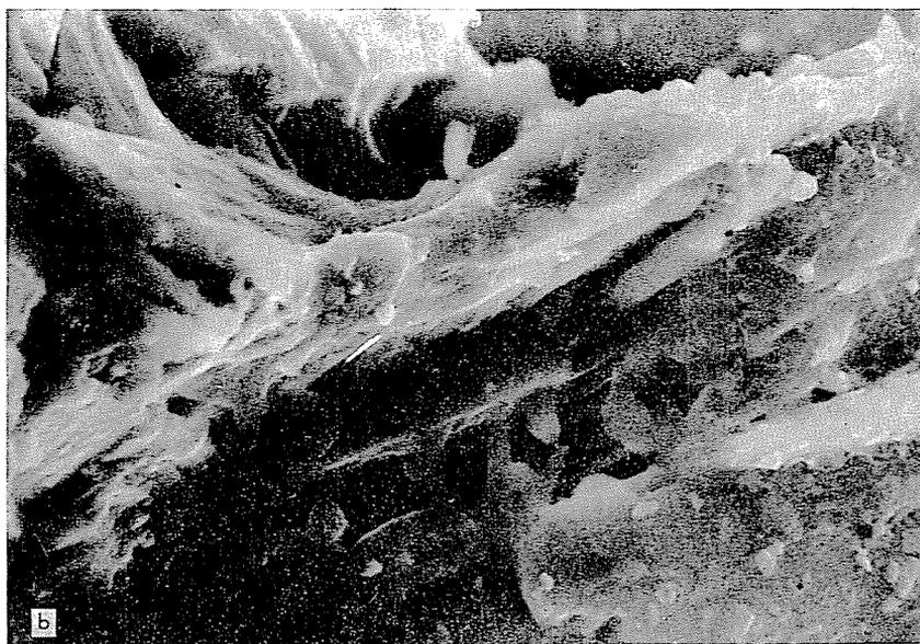
*Fig. 9.* Estructura de una partícula de electrocorindón policristalino (las exposiciones bajo microscopio electrónico de tipo scanning figura 6/a)
