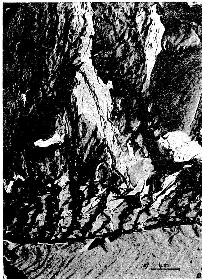
*Fig. 60.* Exposición bajo microscopio electrónico del límite de fase entre el electrocorindón (1) y el material de enlace en fusión (2) de silicato de boro (8000×)
