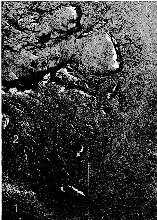
*Fig. 67.* Exposición bajo microscopio electrónico del límite de fase entre el electrocorindón (1) y el material de enlace en fusión (2) de silicato de boro (25 000 $\times$ )
