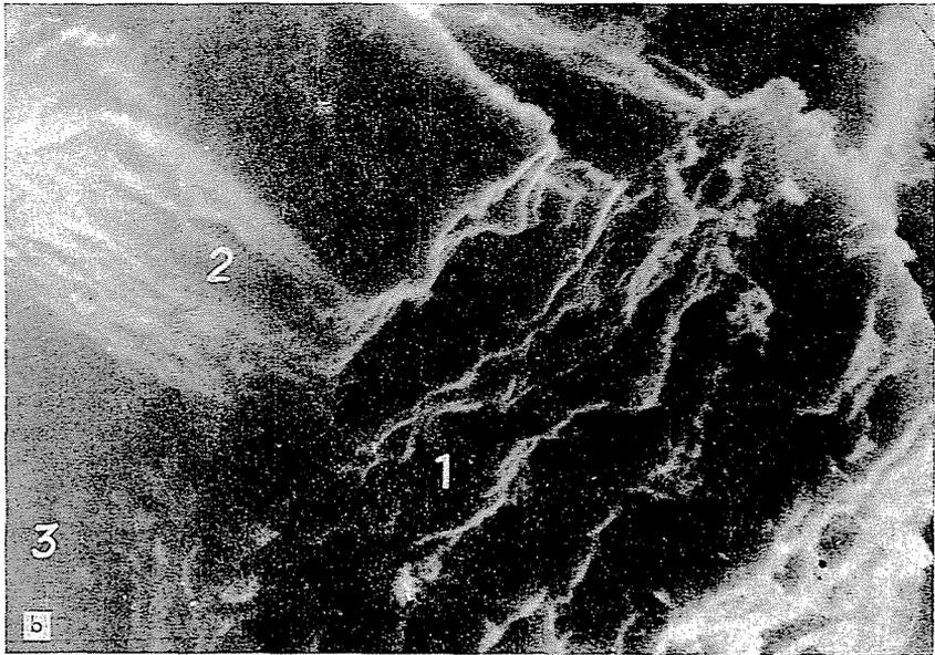
*Fig. 91.* Exposiciones bajo microscopio electrónico de tipo scanning de la superficie de los cuerpos de ensayo de las piedras de esmeril de gránulo de corindón con enlace cerámico, después del quebrantamiento de los mismos. (1 superficie del electrocorindón, 2 puente del material de enlace, 3 poro de aire)
