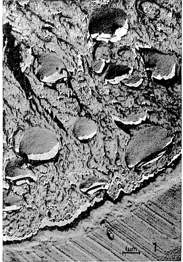
*Fig. 71.* Exposición bajo microscopio electrónico del límite de fase entre el electrocorindón (1) y el material de enlace en fusión (2) de silicato de boro ( $10\ 000\times$ )
