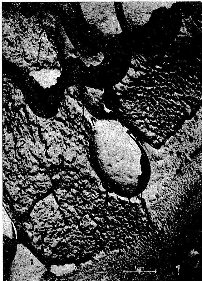
*Fig. 57.* Exposición bajo microscopio electrónico del límite de fase entre el electrocorindón (1) y el material de enlace en fusión (2) de silicato de boro (18 000×)
