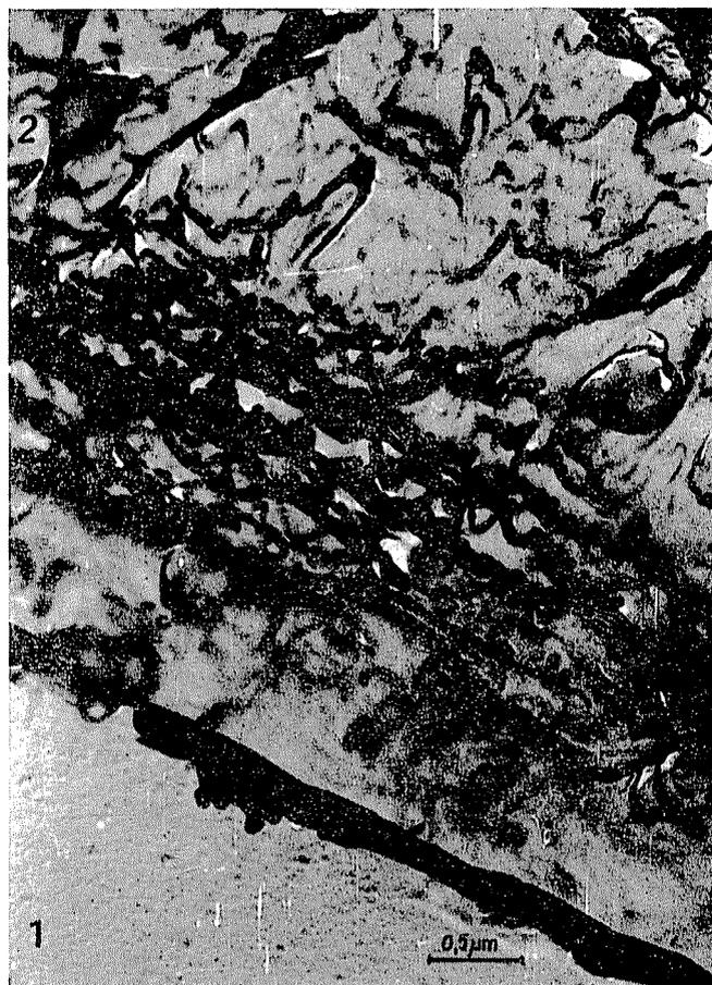
*Fig. 81.* Exposición bajo microscopio electrónico del límite de fase entre el electrocorindón (1) y el material de enlace en fusión (2) de silicato de boro (35 000×)
