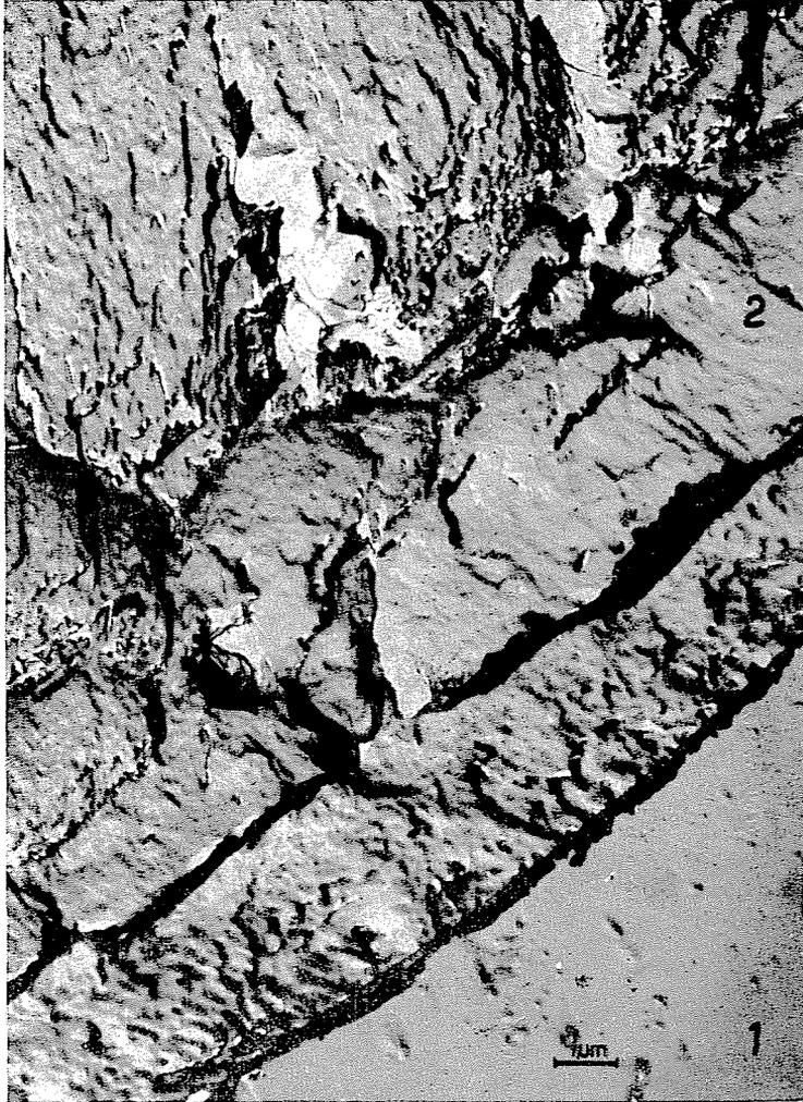
Fig. 61. Exposición bajo microscopio electrónico de límite de fase entre el electrocorindón (1) y el material de enlace en fusión (2) de silicato de boro ( $10\,000\times$ )
