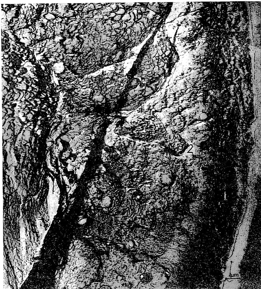
Fig. 85. Exposición bajo microscopio electrónico del límite de fase entre el electrocorindón (1) y el material de enlace en fusión (2) de silicato de boro ( $10\ 000\times$ )
