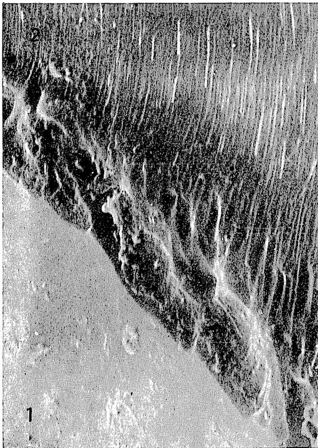
*Fig. 44.* Exposición bajo el microscopio electrónico de tipo scanning del límite de fase entre el electrocorindón (1) y el material de enlace silicato de boro en fusión (2) (6000 $\times$ )
