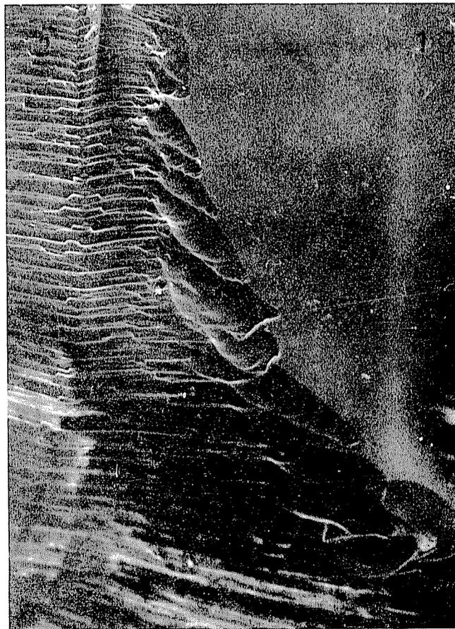
*Fig. 45.* Exposición bajo el microscopio electrónico de tipo scanning del límite de fase entre el electrocorindón (1) y el material de enlace de silicato de boro en fusión (2) (1500 $\times$ )
