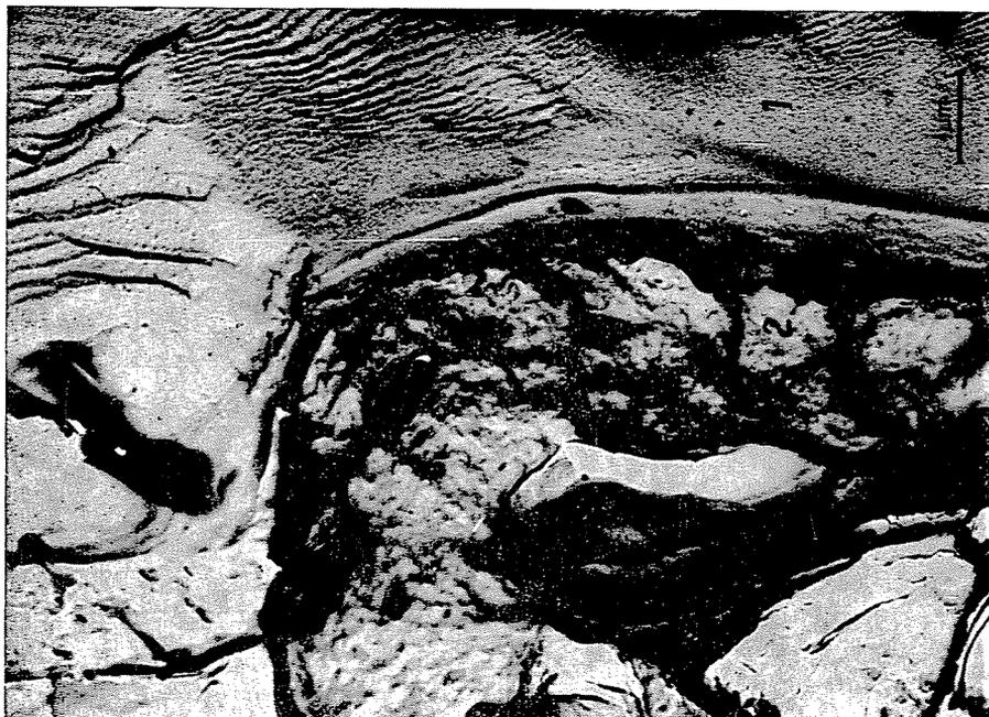
Fig. 56. Exposición bajo microscopio electrónico del límite de fase entre el electrocorindón (1) y el material de enlace en fusión (2) de silicato de boro (16 000 ×).
