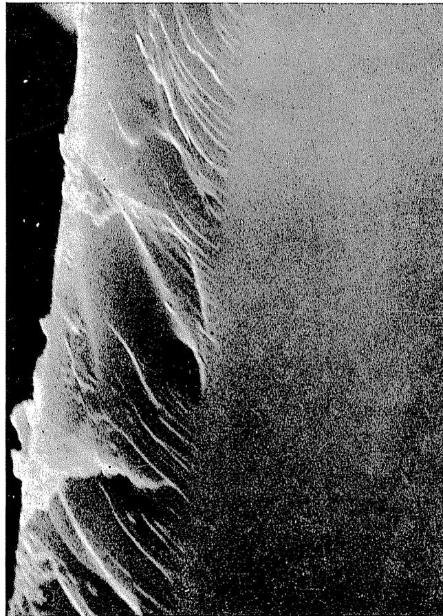
*Fig. 115.* Exposición tomada bajo microscopio electrónico de tipo scanning del límite de fase entre la partícula de carburo de silicio (1) y el material de enlace cerámico (2) (10 000 $\times$ )
