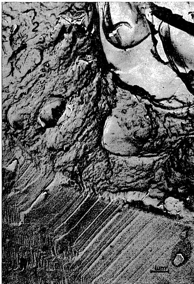
*Fig. 68.* Exposición bajo microscopio electrónico del límite de fase entre el electrocorindón (1) y el material de enlace en fusión (2) de silicato de boro ( $10\ 000\times$ )
