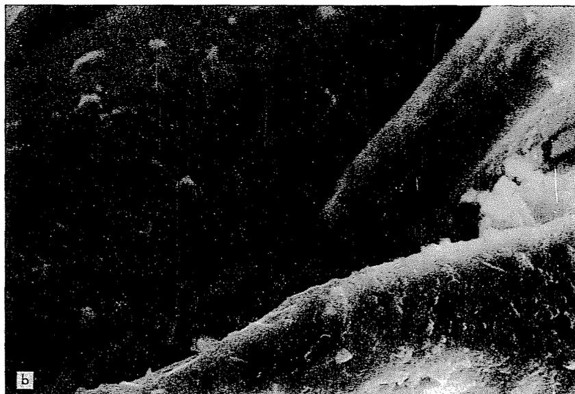
*Fig. 8.* Estructura de una partícula de electrocorindón policristalino (las exposiciones bajo microscopio electrónico de tipo scanning figura 6/a)
