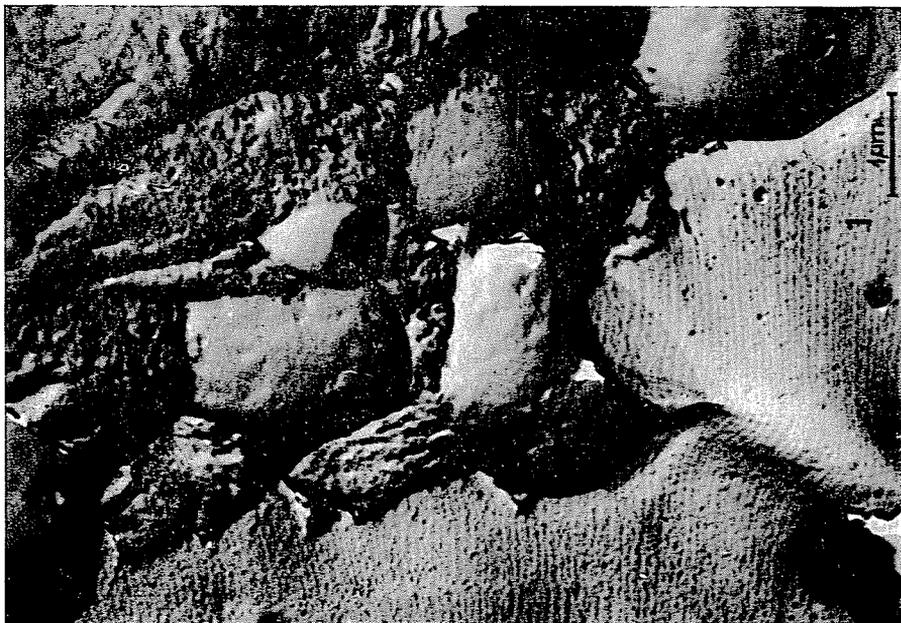
Fig. 55. Exposición bajo microscopio electrónico del límite de fase entre el electrocorindón (1) y el material de enlace en fusión (2) con contenido de silicato de boro (18 000 ×).
