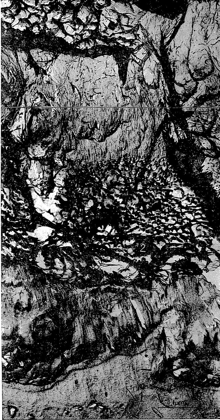
*Fig. 37.* Exposición bajo microscopio electrónico del límite de fase entre el electrocorindón (1) y el material de enlace en fusión (2) de silicato de boro ( $28\ 000\times$ )
