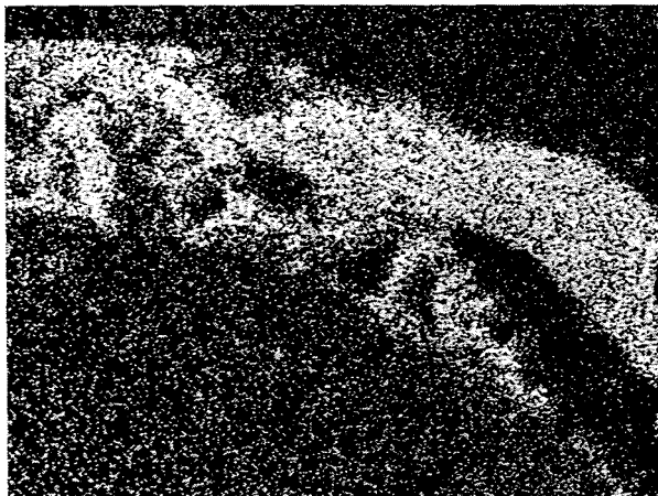
Abb. 14. C-K \alpha -Röntgenbild des Katalysatorquerschnitts auf der in Bild 13 dargestellten Oberfläche, 600 \times
