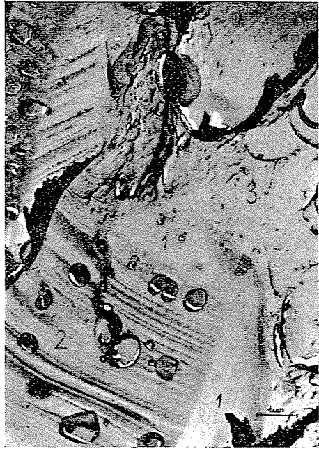
Abb. 26. Durch thermische Behandlung unter optimalen Umständen entstandene Übergangsschicht (1) an der Phasengrenze zwischen Elektrokorundkorn (2) und keramischem Bindemittel (3). Elektronenmikroskopische Aufnahme; 21 500 ×
