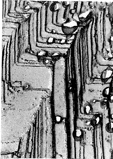
Abb. 23. Elektronenmikroskopische Aufnahme von Korund-Mikrokristallbündeln von unterschiedlicher Größe und Orientierung; 21 000 \times
