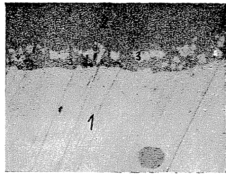
Abb. 18. Lichtmikroskopische Aufnahme von der Korn-Bindemittel-Phasengrenze eines keramisch gebundenen Elektrokorund-Schleifwerkzeugs. In reflektiertem Licht; 500 \times 1 Elektrokorundkorn; 2 Keramisches Bindemittel; 3 Bindschicht
