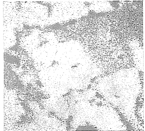
Abb. 7. Al K \alpha -Bild eines Korund-Trägers 1200 \times
