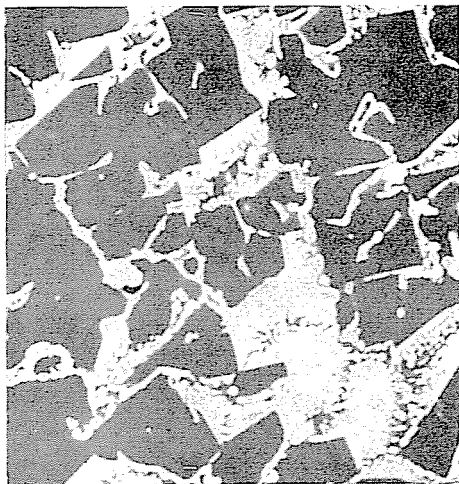
Abb. 4. Zurückgestreutes Elektronenbild eines Korund-Trägers. Zusammensetzungsbild 600 ×
