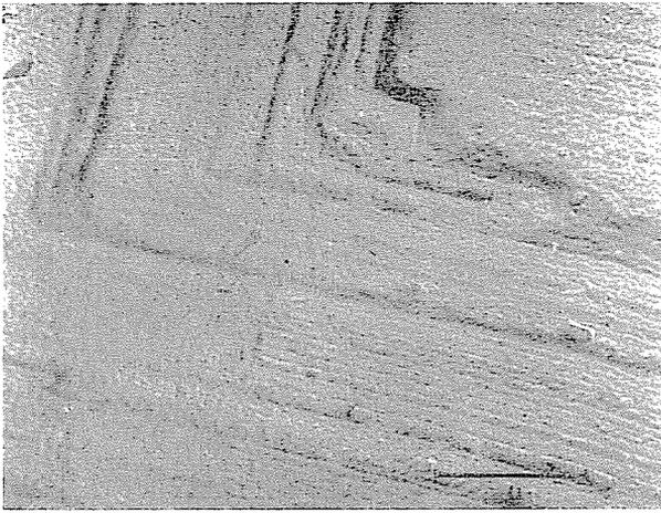
Abb. 5. Elektrokorund mit gestreifter Oberfläche 28 000fach
