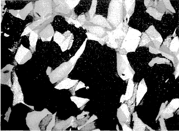
Abb. 3. Keramisch gebundenes SiC-Schleifwerkzeug, 100-fach (weiß = SiC-Körner, grau = keramisches Bindemittel, schwarz = Luftporen)
