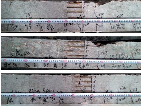
(d) Failure morphology of RSCG-CF beams **Fig. 6** Flexural failure morphology of test beams
