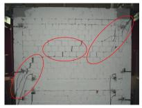
(d) Specimen Kc2 - Sp.1. - shear failure of RC frame, diagonal cracks on infill wall
