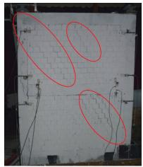
(d) Specimen Km2 - Sp.1. - corner-to-corner cracks
