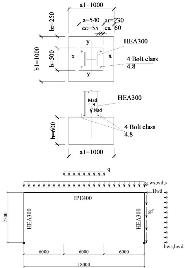
Fig. 5 Geometrical parameters of frame
