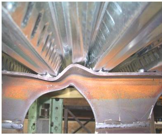
a) Vierendeel mechanism
