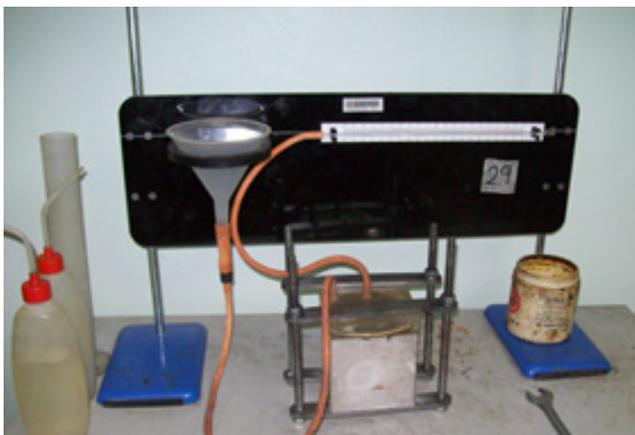
Fig. 7 ISAT apparatus
