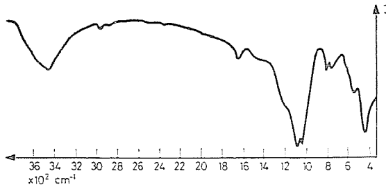
Fig. 3. IR spectrum of pumicite
