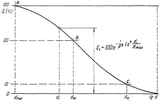
Fig. 3. Grading curve parameters
