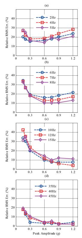
Fig. 6 Relative RMS error versus peak amplitude curves of uncompensated harmonic tests at (a) 2-, 4-, 5-; (b) 6-, 7-, 8-; (c) 10-, 12-, 15- and (d) 35-, 40-, 45-Hz, frequencies
