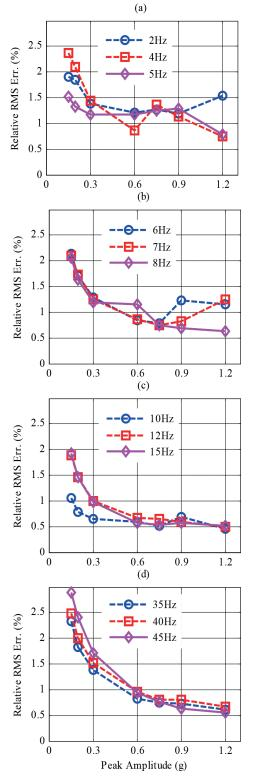
Fig. 7 Relative RMS error versus peak amplitude curves of compensated harmonic tests at (a) 2-, 4-, 5-; (b) 6-, 7-, 8-; (c) 10-, 12-, 15- and (d) 35-, 40-, 45-Hz, frequencies
