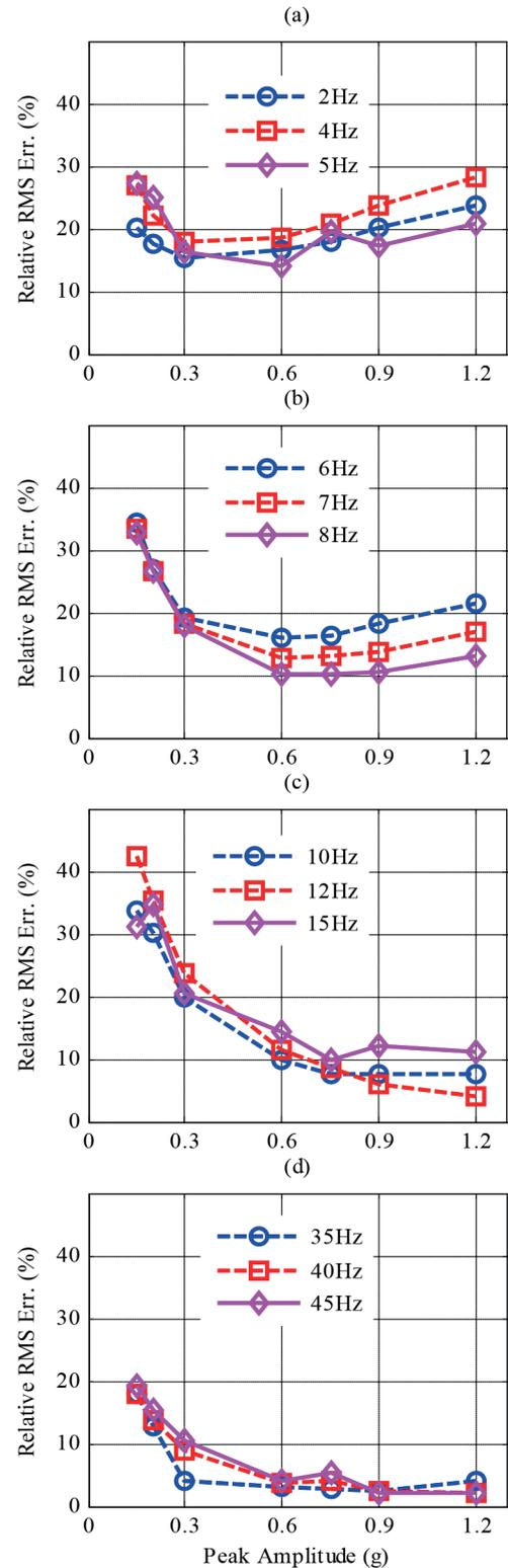
Fig. 6 Relative RMS error versus peak amplitude curves of uncompensated harmonic tests at (a) 2-, 4-, 5-; (b) 6-, 7-, 8-; (c) 10-, 12-, 15- and (d) 35-, 40-, 45-Hz, frequencies
