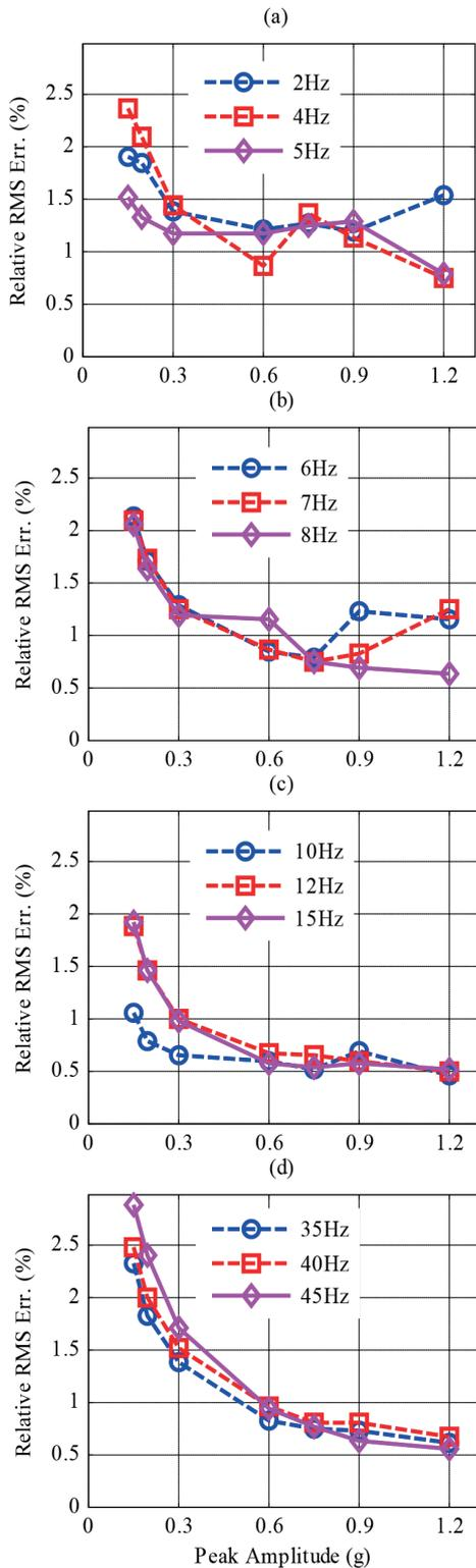
**Fig. 7** Relative RMS error versus peak amplitude curves of compensated harmonic tests at (a) 2-, 4-, 5-; (b) 6-, 7-, 8-; (c) 10-, 12-, 15- and (d) 35-, 40-, 45-Hz, frequencies
