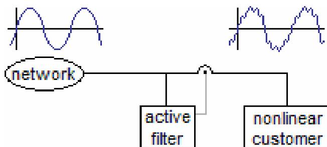
Fig. 20. Active filtering
