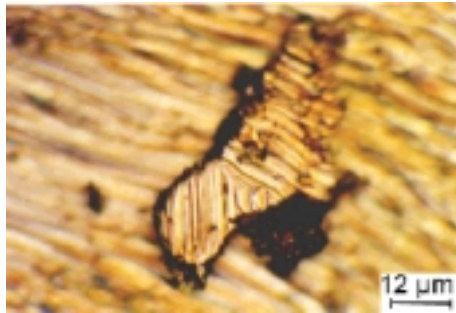
Abbildung 7. Spanüberstreichung (o.V.: \times 1500 )
