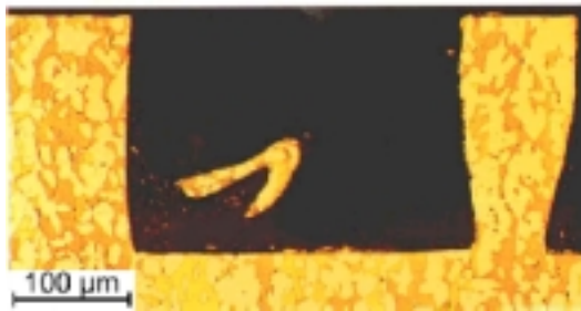
Abbildung 8. Formfehler durch Fräserdeformation (o.V.: \times 150 )
