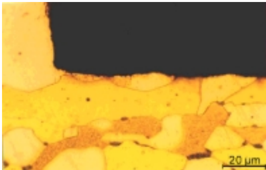
Abbildung 10. Korndurchschnitte bei Messing (o.V.: \times 1000 )
