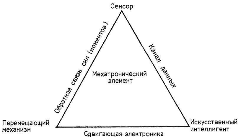
Рис. 2. Схема функций мехатронического элемента
