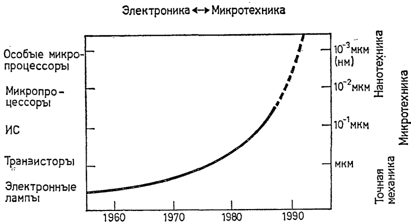
Рис. 3. Поколения электронных элементов и технологии точной механики, обеспечивающие их производства
