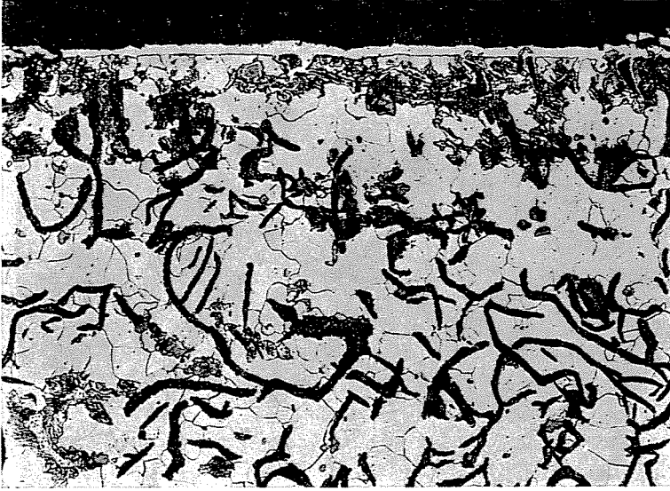
Abb. 4. Grauguß Zl 15; nach 6 Stunden; Vergrößerung 250 ×
