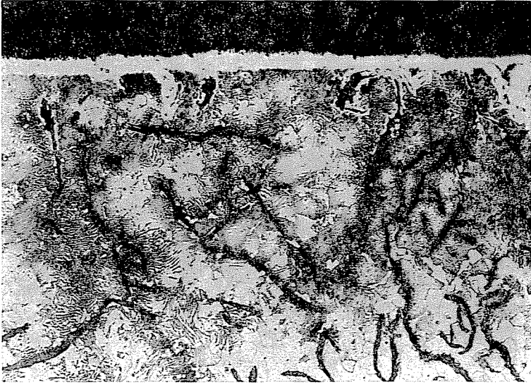
Abb. 6. Grauguß Zl 15; nach 12 Stunden; Vergrößerung 250 ×
