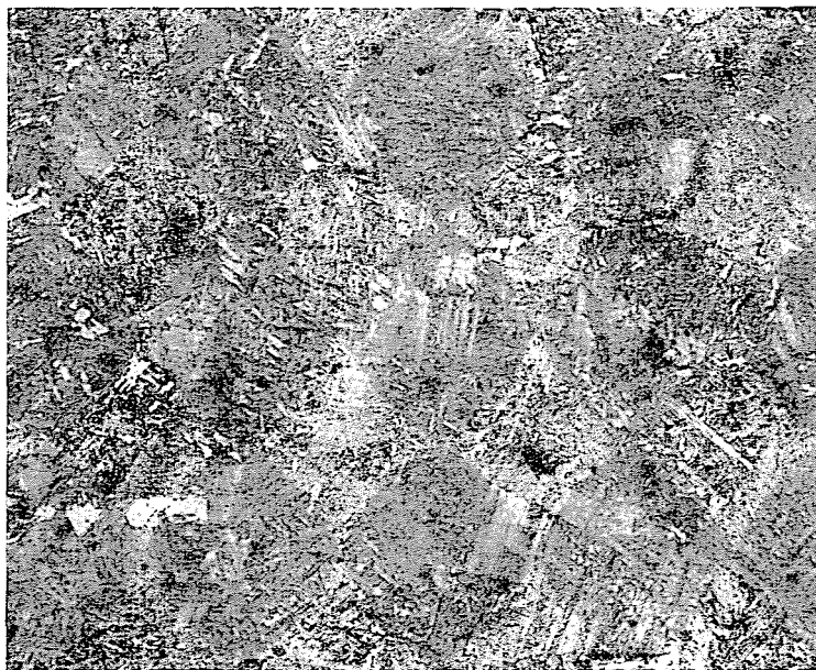
Abb. 3. Mikrostruktur eines oberflächengehärteten Schienenkopfes in der Symmetrieebene. 2 mm unter der Lauffläche 100 ×
