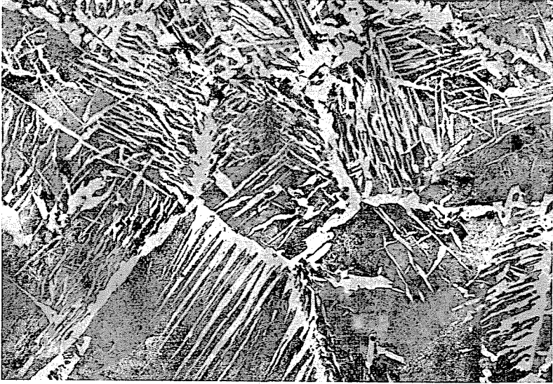
Abb. 6. Mikrostruktur der Verschweißungs-Weißlinie 100 ×
