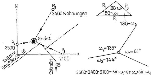
Abb. 5. Allokation der neuen Endhaltestelle in Rákospalota mit Hilfe des VIAL-Modells
