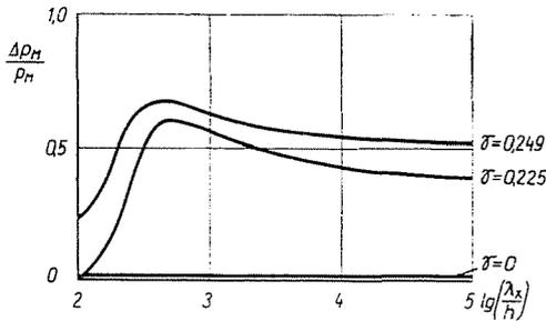
Рис. 2. Относительная погрешность критических сжимающих напряжений
