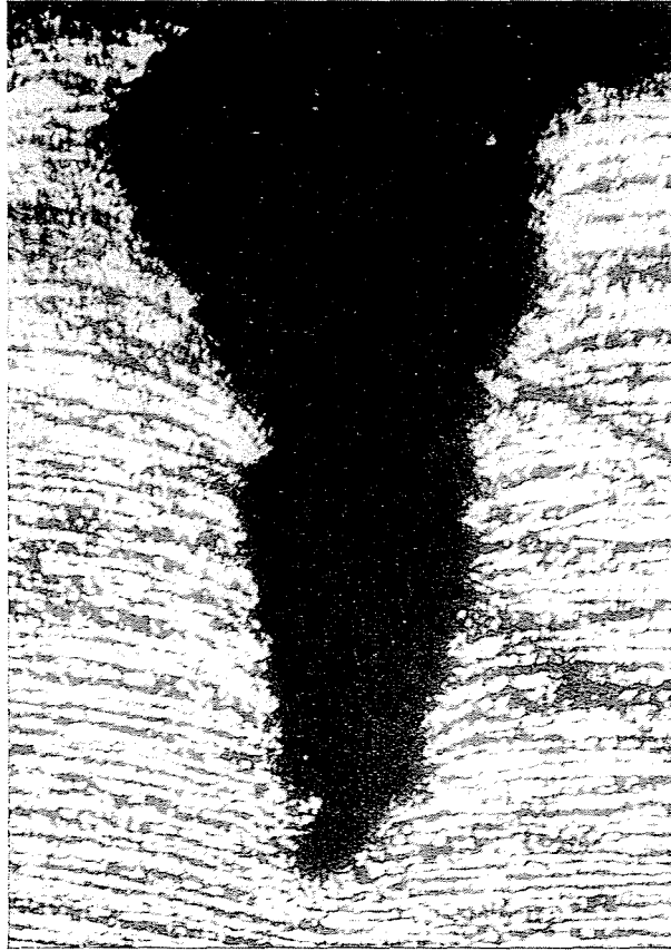
Abb. 21. Querschnitt eines durch Wasserschlag ausgeholten Kraters in Messing ( 50\times )
