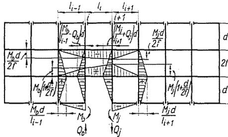
Bild 5. Durch die Tür hervorgerufene zusätzliche Belastung am Grundsystem
