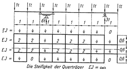
Bild 11. Schema und Belastung des Omnibusrahmens
