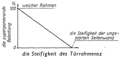
Bild 10. Annähernde Berücksichtigung der Steifigkeit des Türrahmens
