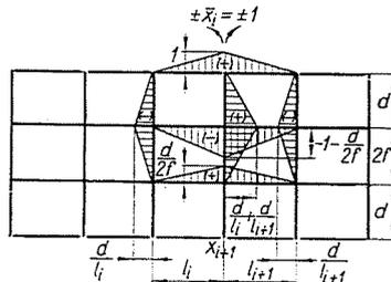
Bild 2. Durch das Einheitsmoment entstehende Belastung am Grundsystem des asymmetrischen Omnibusses
