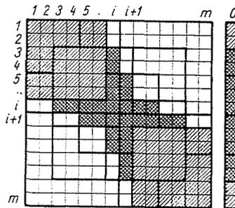
Bild 4. Schema des linearen Gleichungssystems zur Bestimmung der unbekannt inneren Kräfte bei einem mit Tür versehenen Omnibus
