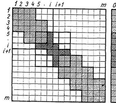
Bild 6. Schema des linearen Gleichungssystems bei unendlich steifen Querträgern
