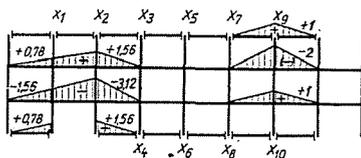
Bild 12. Außen- und Einheitsbelastung am Grundsystem
