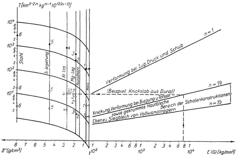
Abb. 16. Gütezahlen der Werkstoffe. Maßgebend ist der Elastizitäts-(Gleit-)Modul
