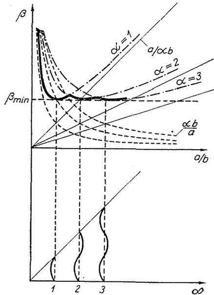
Abb. 10. Entstehung der Zackenkurve
