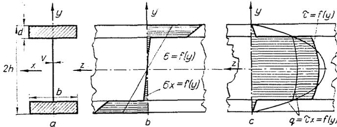
Abb. 17. Normal- und Schubspannungen im Biegeträger
