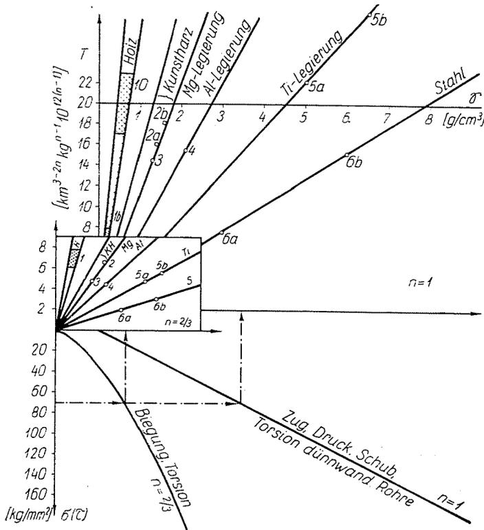
Abb. 15. Gütezahlen der Werkstoffe. Maßgebend ist die Spannung
