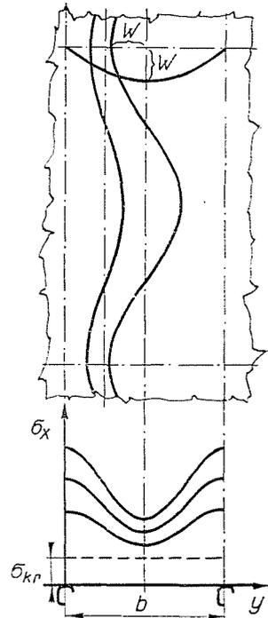
Abb. 13. Spannungsverteilung in der versteiften Schale
