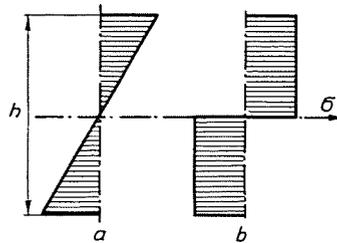
Abb. 5. Spannungsverteilung im rechteckigen Querschnitt eines massiven und eines geteilten Biegeträgers
