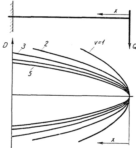
Abb. 6. Freiträger gleicher Festigkeit mit konstanter Wandstärke
