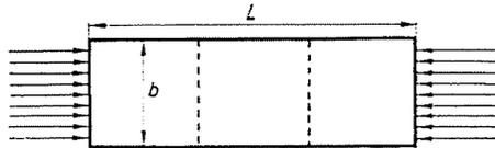
Abb. 9. Belastung eines Blechstreifens auf Knickung
