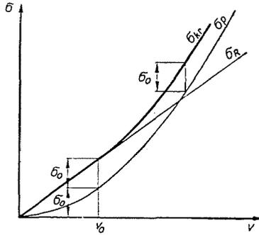
Abb. 11. Kritische Spannung eines Schalenstreifens
