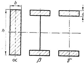
Abb. 4. Günstigster Querschnitt eines Biegeträgers aus Holz
