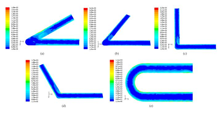
Fig. 11 Contours of vorticity magnitude (1/s) of the bends (a) 30° (b) 60° (c) 90° (d) 120° (e) U-bend, SCMC solution Conc. (kg/m<sup>3</sup>): 0.8, Q<sub>1</sub>(m<sup>3</sup>/s): 20 x 10<sup>-5</sup>
