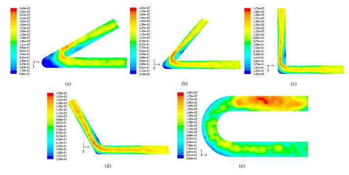
Fig. 9 Contours of Cell Reynolds Number of the bends (a) 30° (b) 60° (c) 90° (d) 120° (e) U-bend, SCMC solution Conc. (kg/m<sup>3</sup>): 0.8, Q<sub>1</sub>(m<sup>3</sup>/s): 20 x 10<sup>-5</sup>
