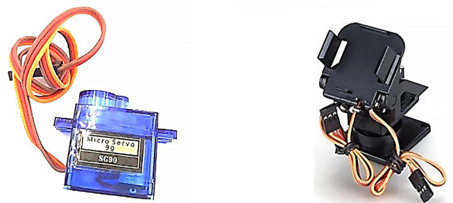
Fig. 13 Camera moving mini servo, camera holder
